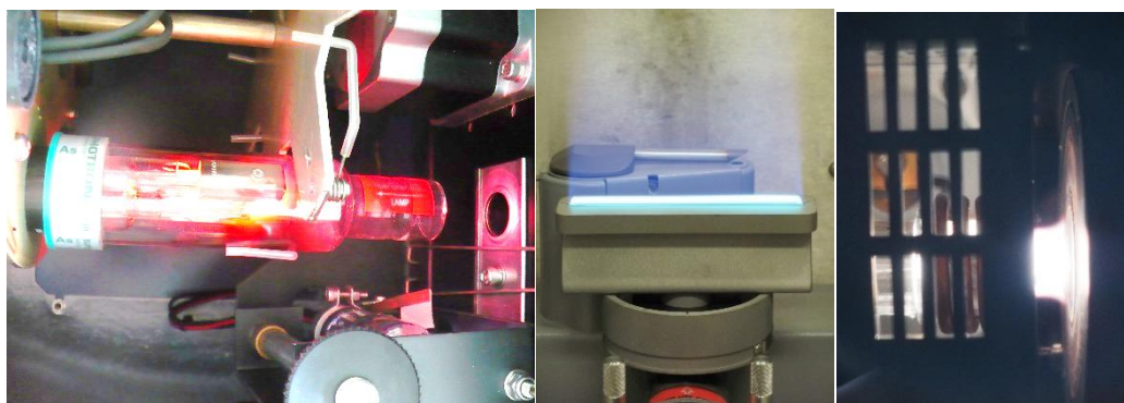
Obr. 25. Výbojka s dutou katodou jako zdroj záření v AAS (vlevo), plamenový atomizátor pro AAS (uprostřed) a indukčně vázané plazma jako zdroj iontů pro ICP-MS (vpravo).
