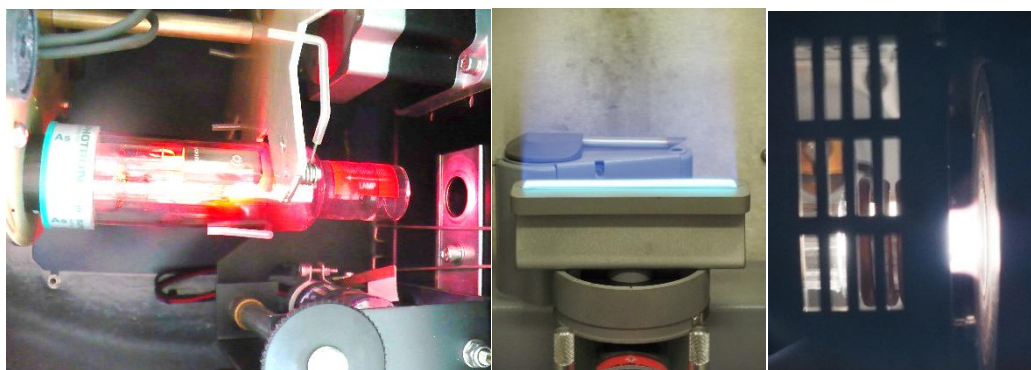
Obr. 25. Výbojka s dutou katodou jako zdroj záření v AAS (vlevo), plamenový atomizátor pro AAS (uprostřed) a indukčně vázané plazma jako zdroj iontů pro ICP-MS (vpravo).
