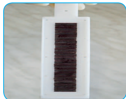
Sonda pro techniku difúzního gradientu v tenkém filmu (vlevo) a koncentrační profil uranu v sedimentu (vpravo) zjištěný touto sondou a technikou difúzní rovnováhy.
