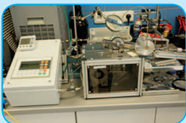
Přístroj pro leptání kapilár z taveného křemene superkritickou vodou.
