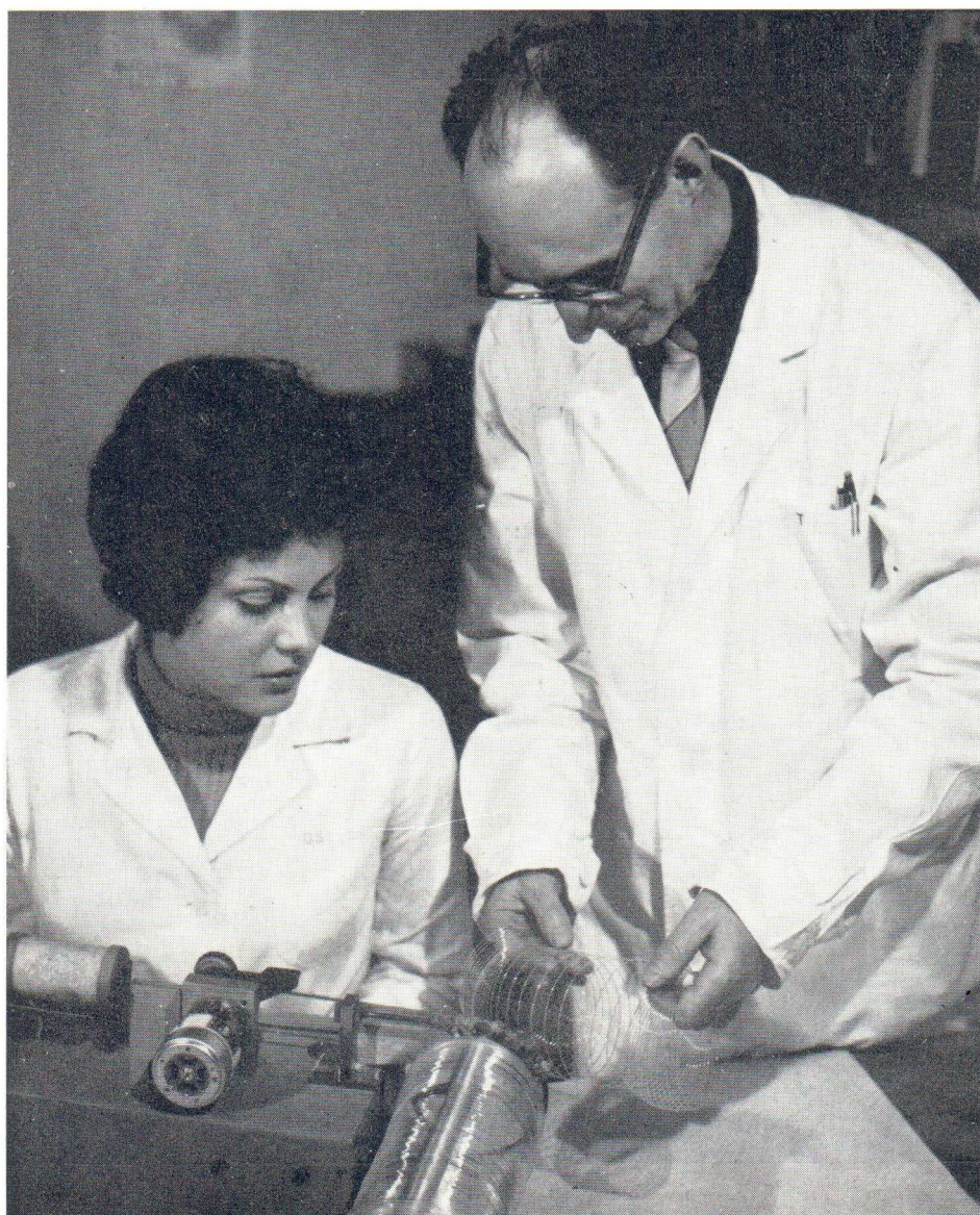
Tažení speciálních skleněných kapilárních kolon na přístroji zkonstruovaném v ústavu podle návrhu RNDr. K. Tesaříka. Kolony dosahují účinnosti až 7000 teoretických pater/m. (RNDr. K. Tesařík, O. Smolová)
